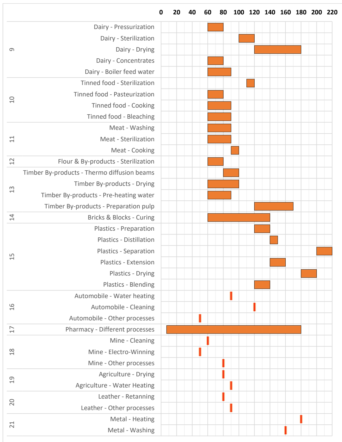
Figura 5.2 - Livelli di temperatura richiesti per processo e per settore merceologico (2/2). [Fonte: Elaborazione Fondazione Politecnico su dati di Farjana et al. [40]]
